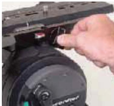
新型便捷安裝系統，帶有一個推按旋鈕便於迅速準確的進行前後調整，使用這種機械系統，重型的攝影機也可輕鬆前後移動。
